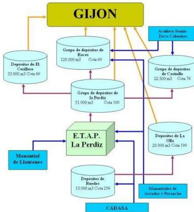
*Ciclo del agua: Suministro, Conducción y Depósitos en Gijón. Fuente: Aguas de Gijón/Xixón.*
